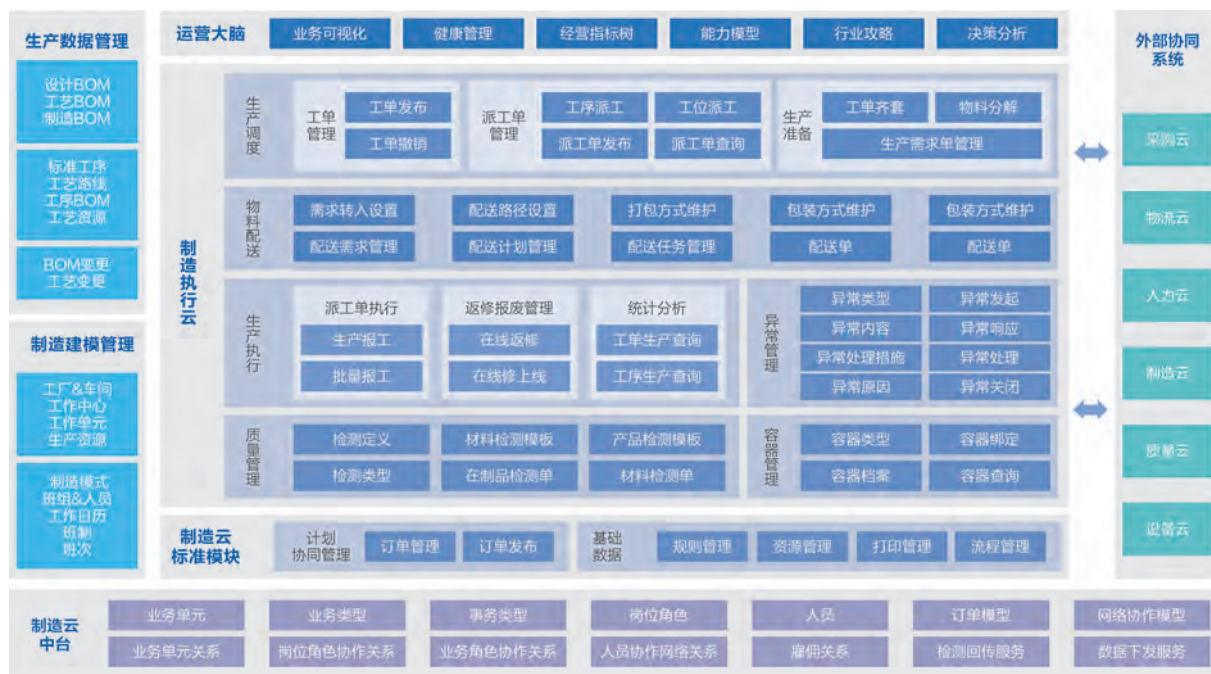
图 58：制造执行系统架构图
