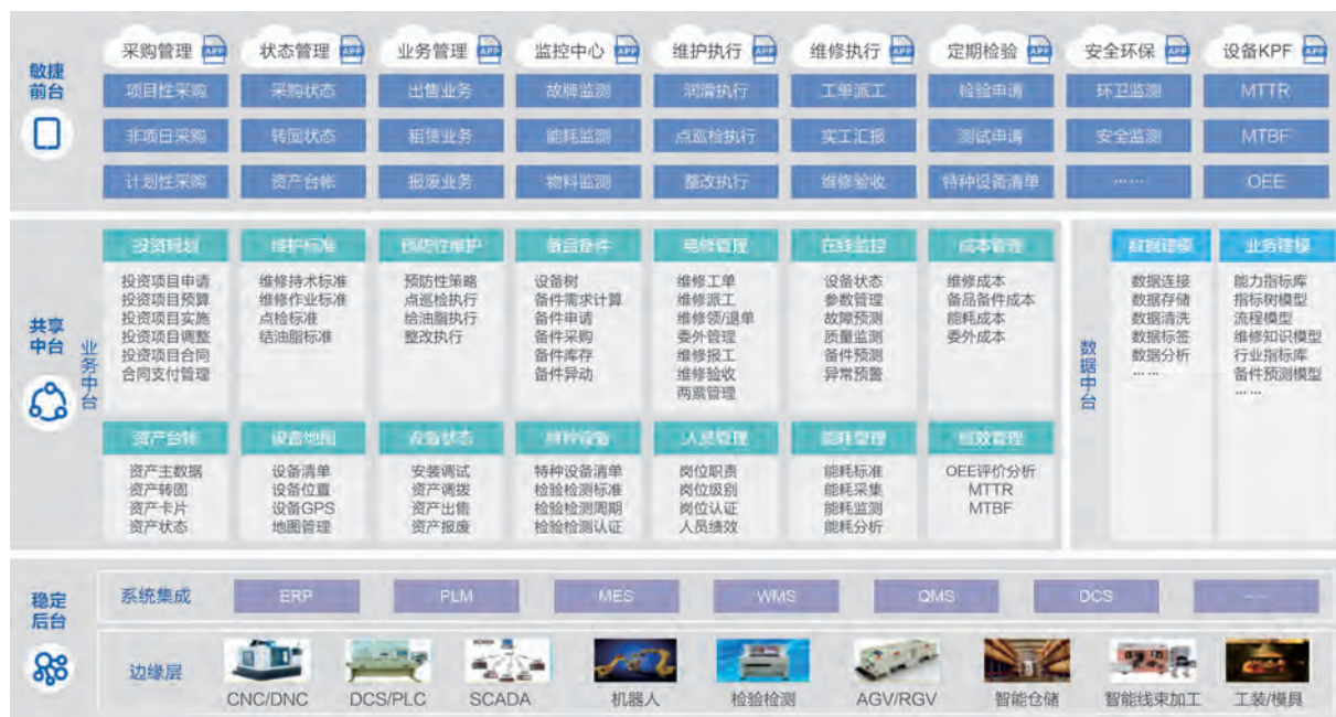
图 59：设备管理架构图
